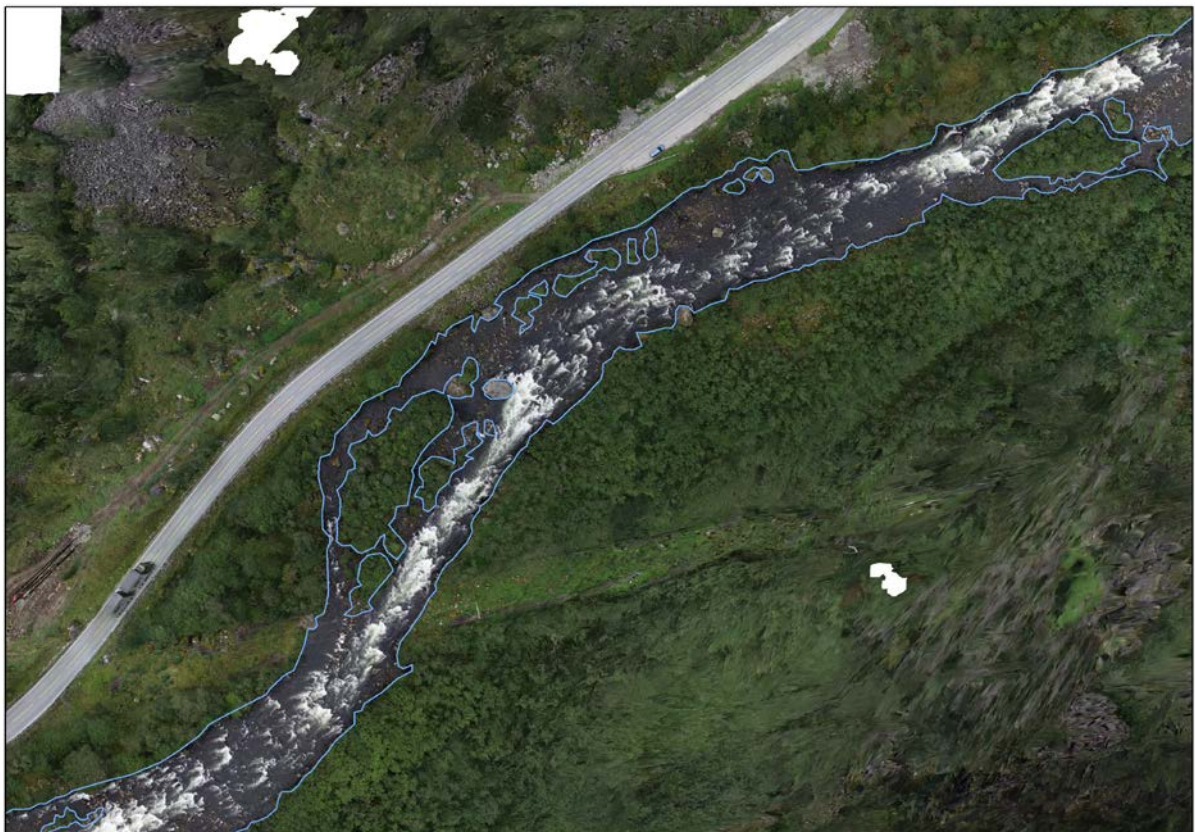
Figur 3. Eksempel på oppmåling av vanddekket areal basert på ortofoto generert fra dronekartlegginger den 27.11.2018 (øverst) og den 03.09.2019 (nederst).
