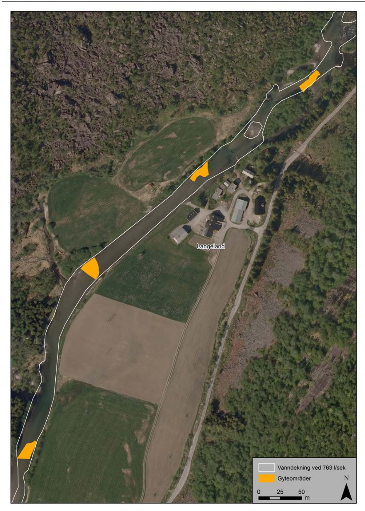
Figur 16. Sammenheng mellom vannføring og vandekning over de viktigste gyteområdene ved Langeland i Teigdalselva ved vannføring på 763 l/s ved Mestad (differensiell GPS 2008).
