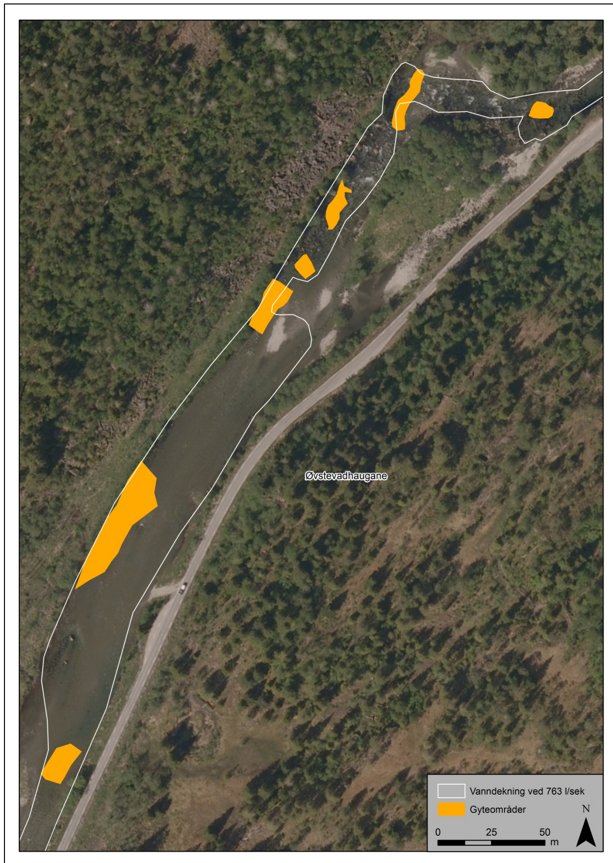
Figur 15. Sammenheng mellom vannføring og vandekning over de viktigste gyteområdene ved Øvstevadhaugane i Teigdalselva ved vannføring på 763 l/s ved Mestad (differensiell GPS 2008).
