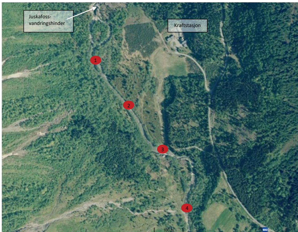
Figur 11. Oversikt over de fire foreslåtte lokalitetene hvor det ble lagt ut gytegrus. Moderate terrengjusteringer ble utført for å sikre gytegrusen bedre mot utspyling ved stor flom på områdene.
