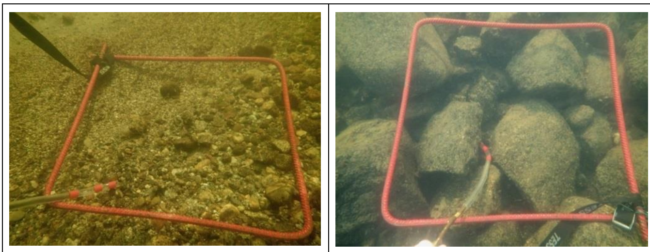
Figur 3. Skjulforhold for ungfisk vert målt ved å kvantifisere tal og storleik på holrom i elvebotn med ein plastslange (såkalt substrat-o-meter) innanfor ei rute på 0,25 m 2 . Slangen er markert med markørar som nyttast til å måle djupna av holromma. Eksempel på skjulumålingar i substrat med mykje fin grus og sand der det ikkje finst holrom, og med det svært lite skjul (t.v.), og i substrat med stein/blokk som gir mykje skjul (t.h.).
