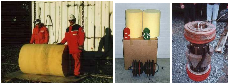
Figur 6. Ulike typer pigger for rensing av rørledninger. Foto: ITAS, Stavanger.
