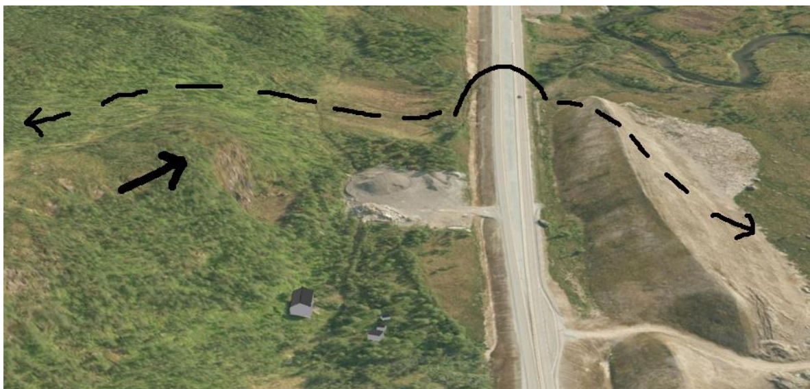
Figur 39. Skredforbygning ved Sarasteinen. Uttak av stein er vist med pil. Flyttlei med overgang er vist med stiptet linje.
