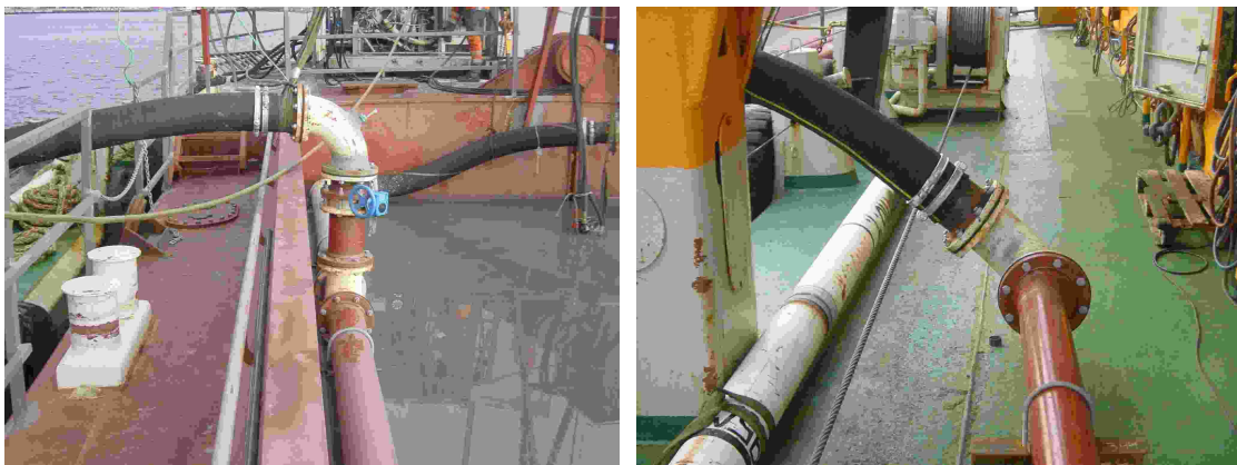
Figur 3.5. Til venstre T-kopling i lektar, påkoplingspunkt mellom lektar og utleggerfartøy, til høyre overgang til utleggerfartøy.
