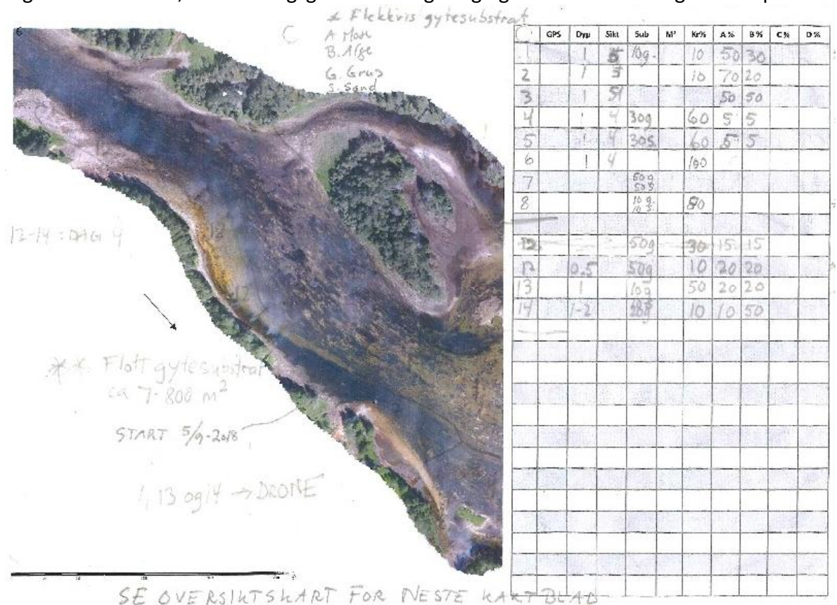
Figur 1. Otra ved Strårøne. Elvebunnen ble kartlagt ved at polygoner ble tegnet rundt områder med uniform dekningsgrad av ulike vannplanter og substrat. Polygonene ble deretter digitalisert.
