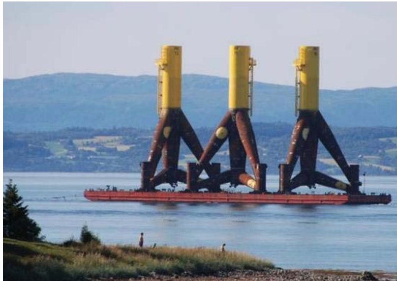
Figur 6-6 Tre stålunderstell på vei ut Trondheimsfjorden til Tysklands første offshore vindkraftprosjekt. Foto: Aker Solutions.
