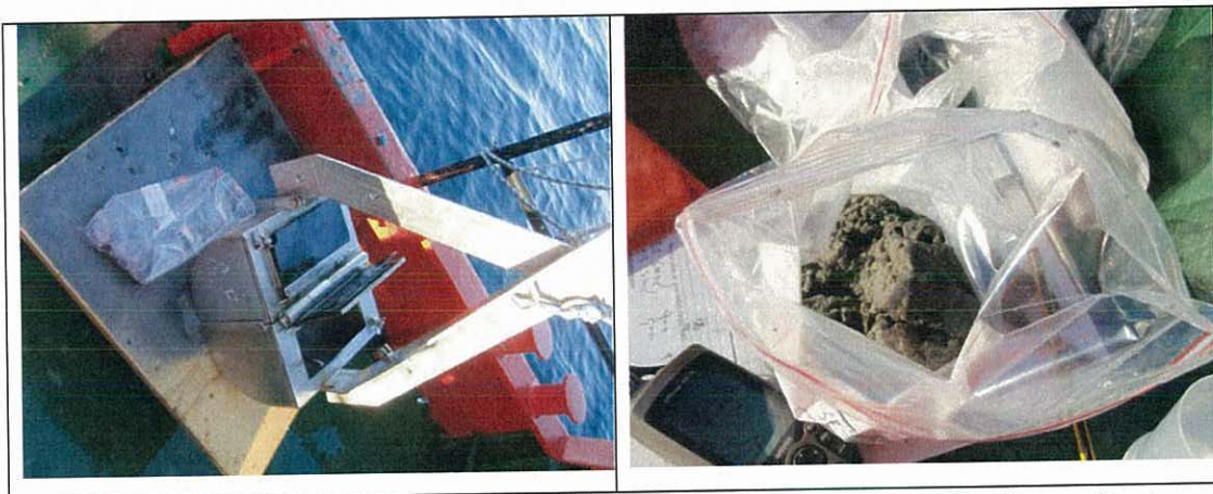
Figur 3: Van Veen grabb som ble benyttet ved sedimentprøvetakingen og prøve pakket for metallanalyse.
