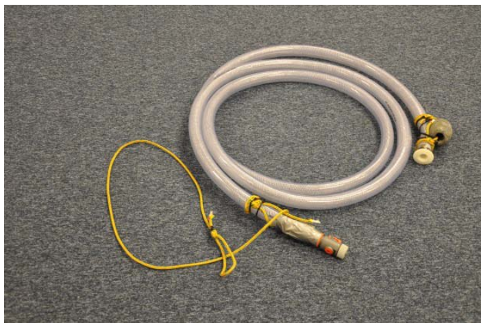
Figur 2: Prøvetakeren som ble benyttet for innsamling av vann til klorofyll a målinger. Denne består av en 5 m slange som samler ca 5 L vann fra overflaten til 5 m dyp. Dette vannet helles over i en beholder hvor det blandes godt før deler av blandingen overføres til analyseflaske (1 L) (Bilde Marianne Nilsen, IRIS)
