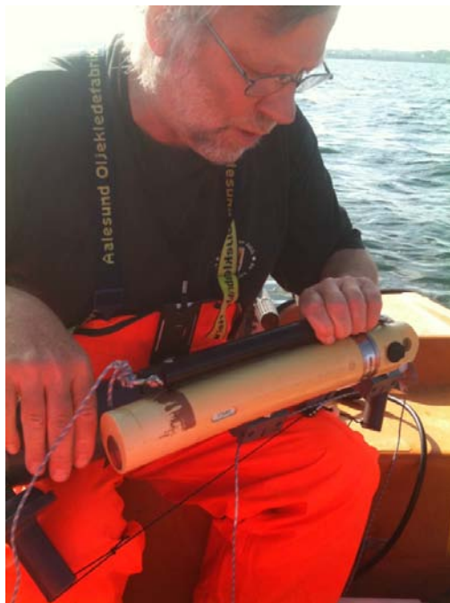
Figur 5: CTD SD200 som ble benyttet under prøvetaking (Bilde Anne Helene Solberg Tandberg, IRIS).
