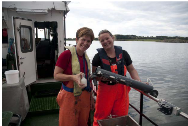
Figur 4: Niskin vannhenter som ble benyttet under prøvetaking (Bilde Stig Westerlund, IRIS)
