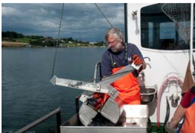
Figur 3: van Veen grabb benyttet for prøvetaking av sedimenter. Grabben samler et areal på 0.1 m 2 (Bilde Anne Helene Solberg Tandberg, IRIS).
