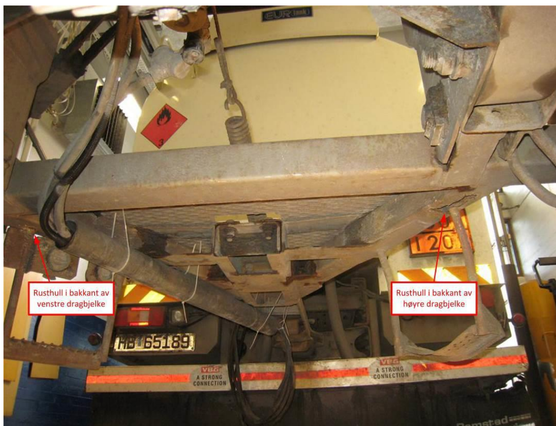
Figur 5.22: Rustskader i tilhengerdrag påvist i kontroll hos Statens vegvesen i mai 2011. Foto: Statens vegvesen
