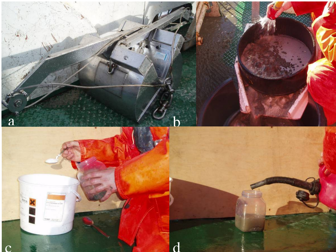
Figur 4. 2. a) Til sedimentprøvetakingen ble det benyttet en 0,1 m 2 van Veen grabb. b) Sedimentet blir deretter vasket gjennom to sikter, der den første sikten har hull diameter 5 mm og den andre 1 mm. c) Prøvene blir deretter samlet i et glass tilsatt borax. d) Fiksert med 4 % formalinløsning.
