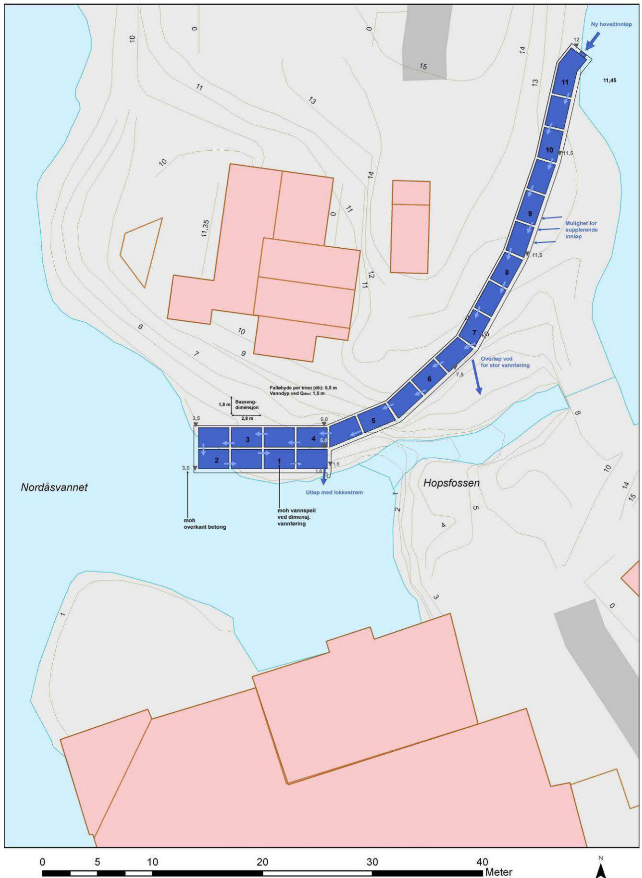
Figur 20 Utkast til en kulpetrapp som oppfylder de ønskete fiskebiologiske kravene og som integreres i fjellet på nordsiden av Hopsfossen.
