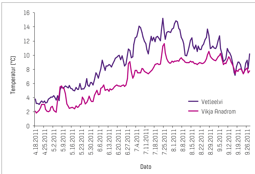
Figur 11. Gjennomsnittlig vanntemperatur basert på målinger hver 2. time i Vetleelvi og i Vikja nedstrøms Hove kraftstasjon (Vikja anadrom) fra april-oktober 2011.
