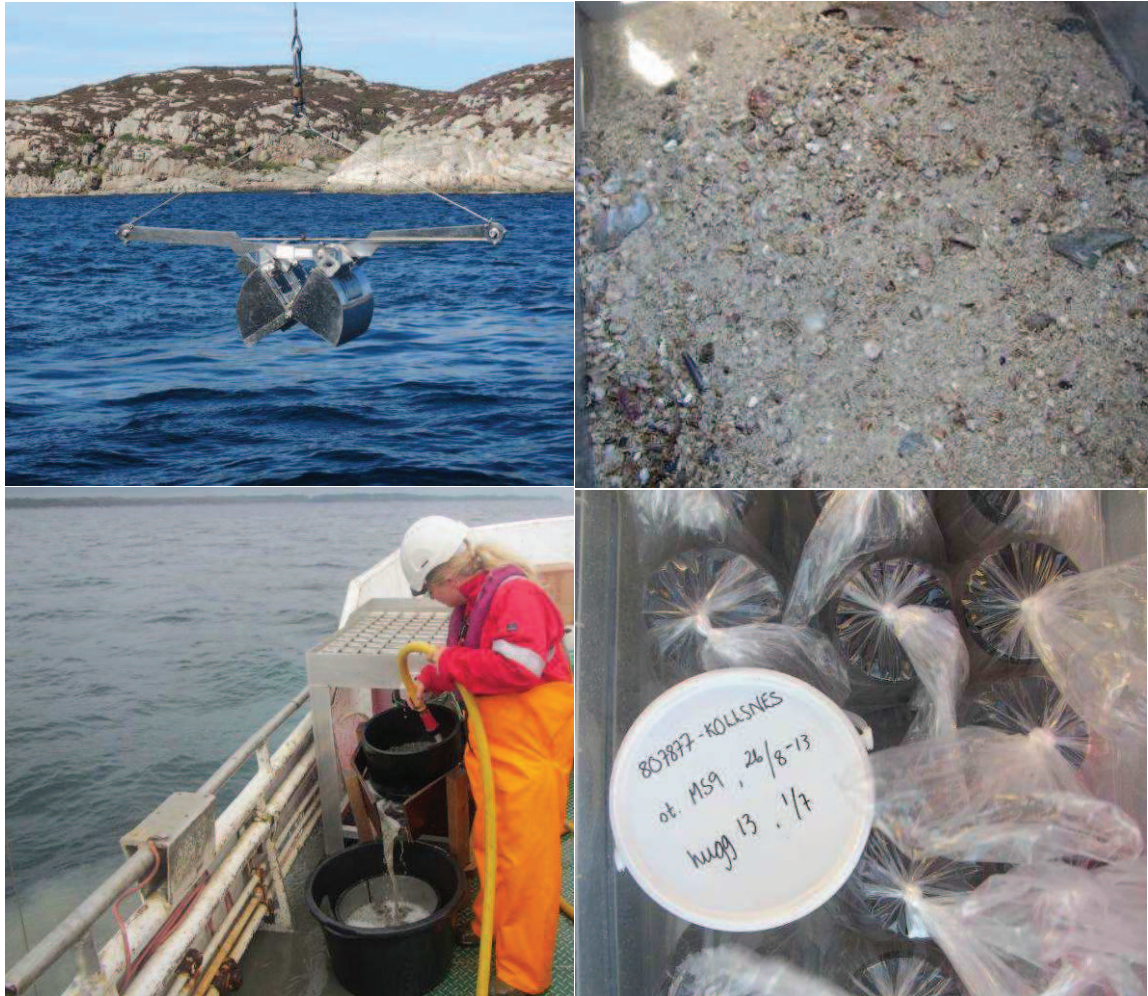
Illustrasjonsfoto: Bilder fra referansestasjon MS9 i 2013. Fra øverst til venstre: Prøvetaking fra bunnstasjoner med kortarmet van Veen grabb, Skjellsand i grabben, skylling av prøvene, fikserte og merkede biologiske prøver.
