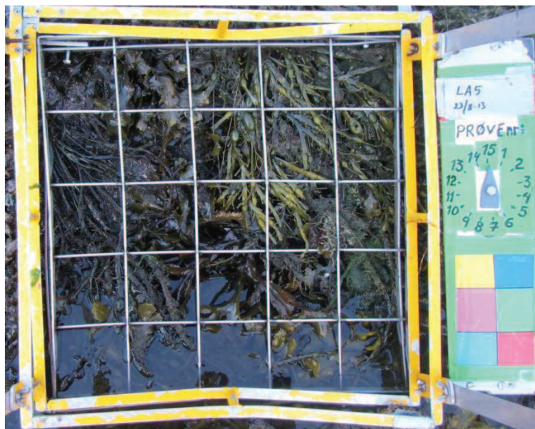
Illustrasjonsfoto: Eksempel på ikke akkreditert prøverute, fordi ti av delrutene er helt eller delvis under vann (foto: SAM-Marin).
