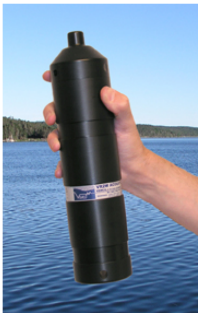
Figur 5.9. Lyttebøye fra VEMCO (VR2W – 69 kHz)
