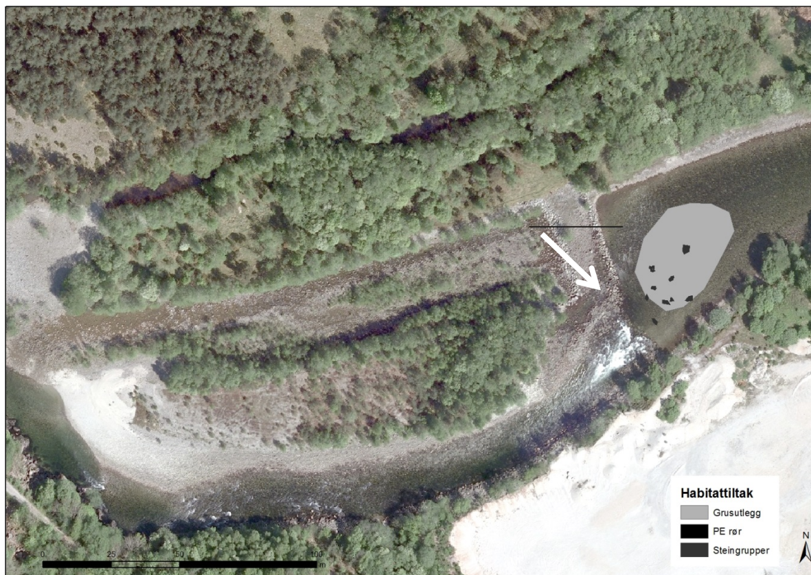
Figur 24: Terskel på utløp av høl nedom Storå bru (T5) vist med rør/grøft for fraføring av vann ut til sideløp. Utlegging av steingrupper og gytegrus er tegnet inn som eksempel, men er ikke ment å vise den nøyaktige plassering av disse i detalj.
