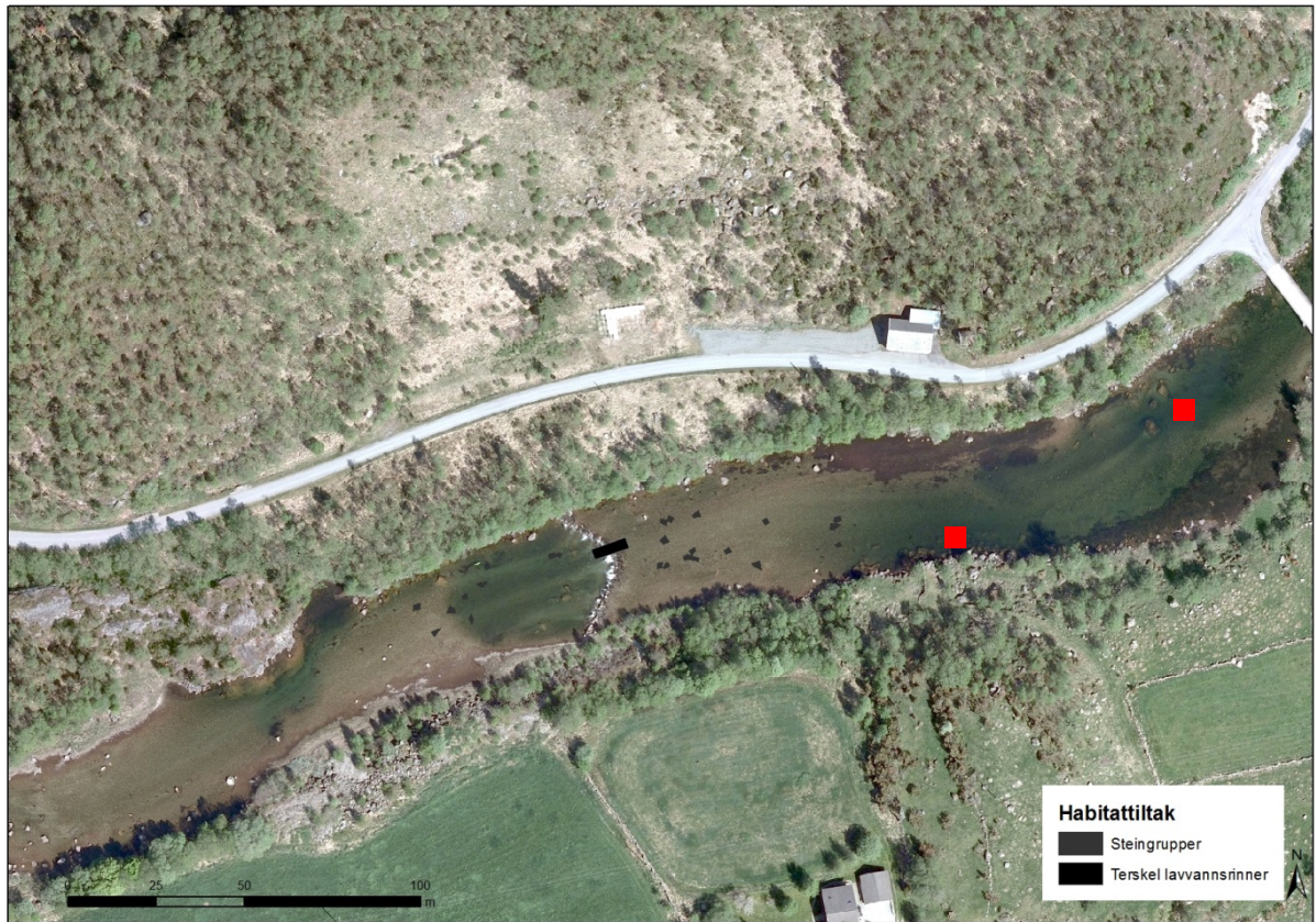
Figur 19: Terskel i Kvalahølen (T23), vist med lavvannsrinne. Utlegging av steingrupper er tegnet inn som eksempel, men er ikke ment å vise den nøyaktige plassering av disse i detalj. Røde punkt viser typiske standplasser for fisk.
