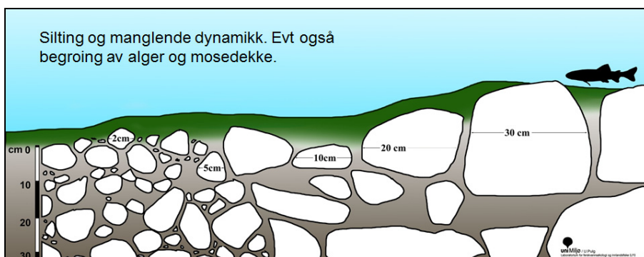
Figur 2: Ungfisken lever både i og over bunnsubstratet. Ovenfor illustreres fire ulike nivå av sedimentering og gjenfylling av hulromsvolum, avhengig av vannhastighet og av grad av partikkeltransport/-sortering. (Grafikk: Ulrich Pulg, LFI)
