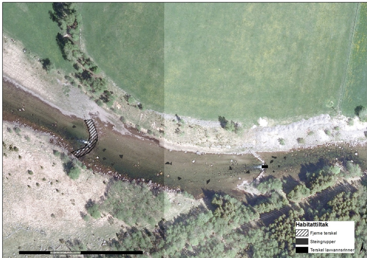
Figur 13: Tersklene ovenfor Selshølen (T26 venstre og T27 høyre), med T26 indikert som fjernet og T27 med lavvannsrinne. Utlegging av steingrupper er tegnet inn som eksempel, men er ikke ment å vise den nøyaktige plassering av disse i detalj.
