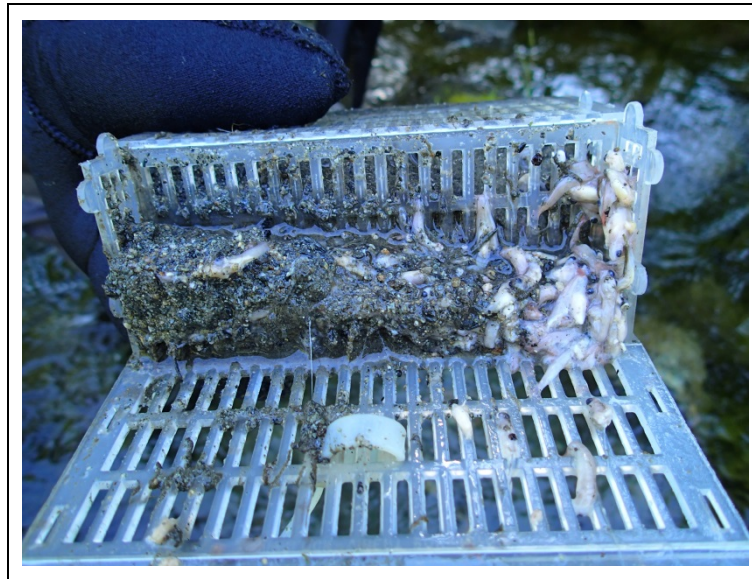
Bilde 7. I noen av Vibert boksene ble det observert finsediment og lavere overlevelse. Bildet viser døde plommesekkyngel, trolig som følge av surstoffmangel. Graden av sedimentering og tidspunktet for når dette skjer, er avgjørende for om eggene eller plommesekkene klarer seg frem til «swim-up».
