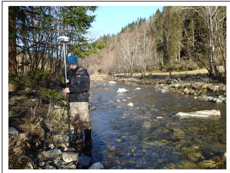
Bilde 14. Oppmålingen av det biotopjusterte restfeltet med en differensiell GPS mars 2015.
