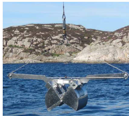
Figur 2-8 Danskegrabb klar for prøvetaking av bunnsediment.
