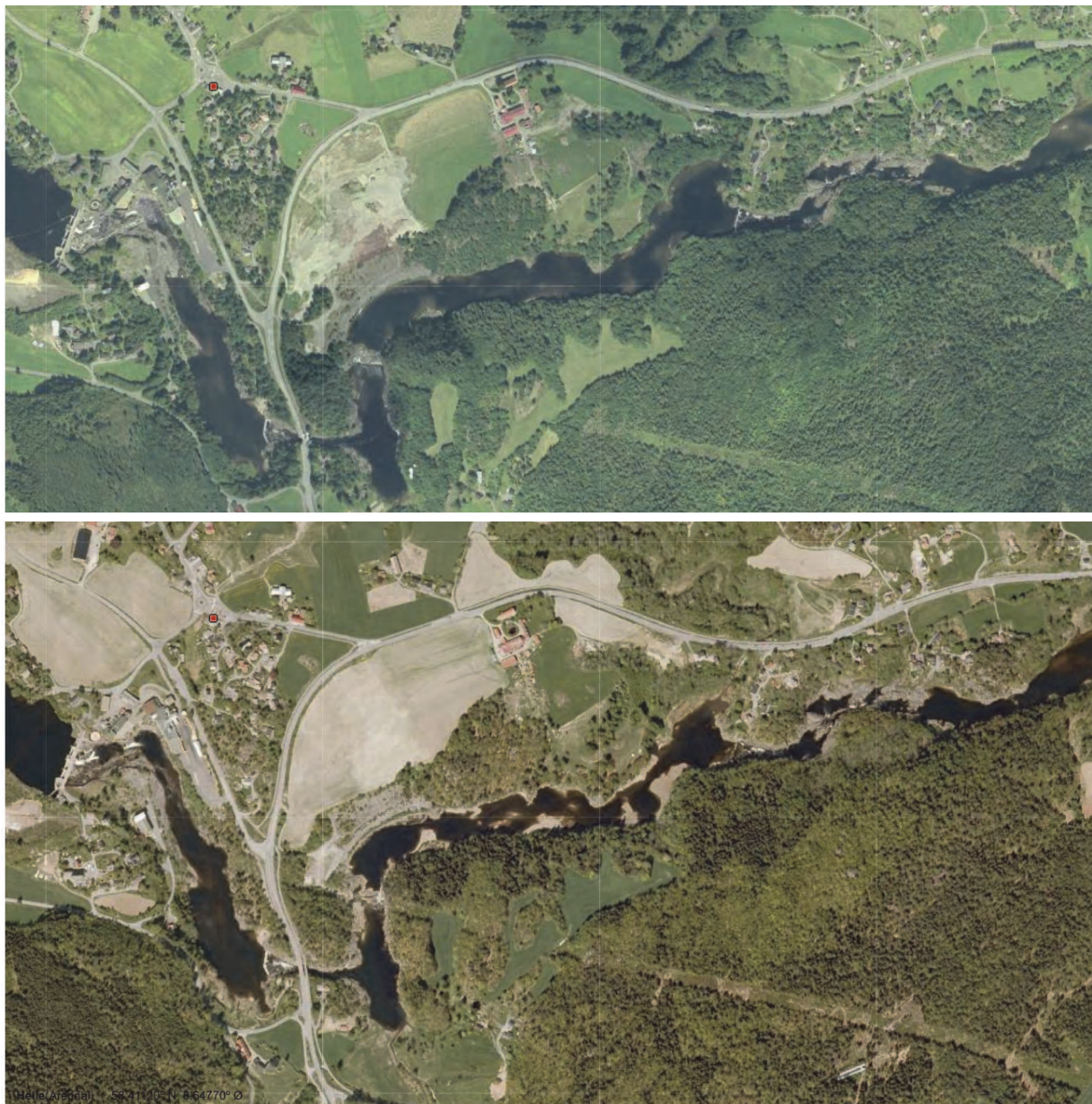
Fig. 83 Flyfoto av restfeltstrekningen mellom Rykene og Helle før (øverste bildet) og etter rivningen av de to tersklene i 2007 (nederste bildet). Flyfotoene er hentet på Finn.no.
