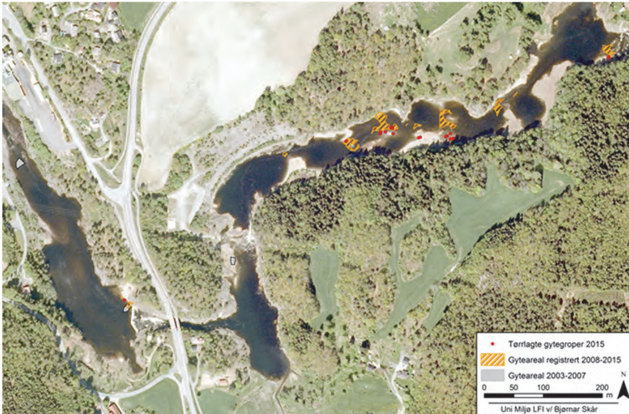
Fig. 84 Oversikt over registrerte gytegrøper i restfeltstrekningen mellom Rykene og Helle i Nidelva i perioden 2003-2015. De grå områdene er fra før tersklene ble revet, mens oransje områder er i perioden etter. De oransje områdene er nye gyteområder som er blitt tilgjengelig etter at gytefisker og vannstrømmen har bearbeidet og løsnet opp gytegrusen. Denne gytegrusen var kittet fast i elvebunnen på grunn av lav vannhastighet, som følge av at disse tidligere lå i terskelbassengene. I 2015 ble det registrert noen tørrlagte gytegrøper vist som røde punkter.
