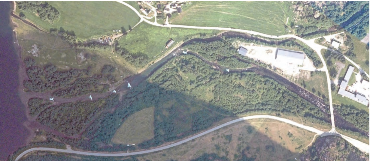
Fig. 6 Flyfoto fra 2013 som viser Vassbygdelva i Aurland etter kraftregulering og kanalisering. Kunnskap om situasjonen før regulering ble til utgangspunkt for planlegging av miljøtiltak i Aurlandsvassdraget, i dette tilfelle restaurering av flere sideløp i det gamle deltaet i 2017 ( www.norgedigitalt.no )
