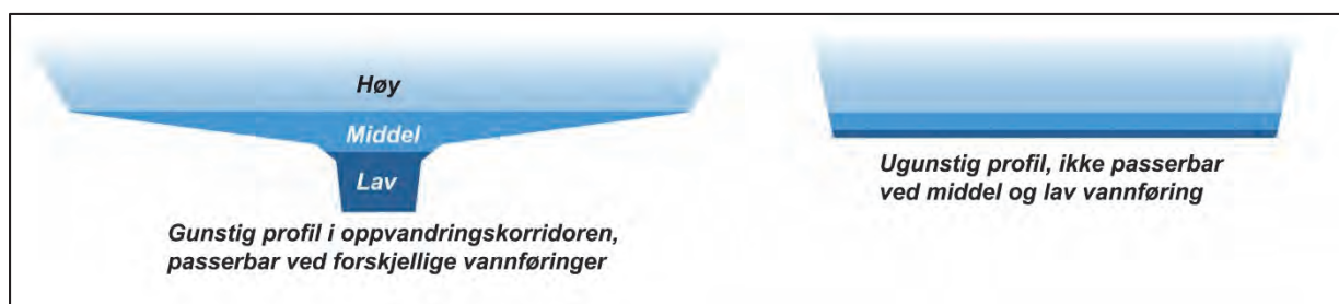
Fig. 25 Prinsippskisse av tverrprofil: Det anbefales en V-formet profil med dypål (lavvannsrenne) som sikrer vandringsmuligheter ved varierende vannføringer.
