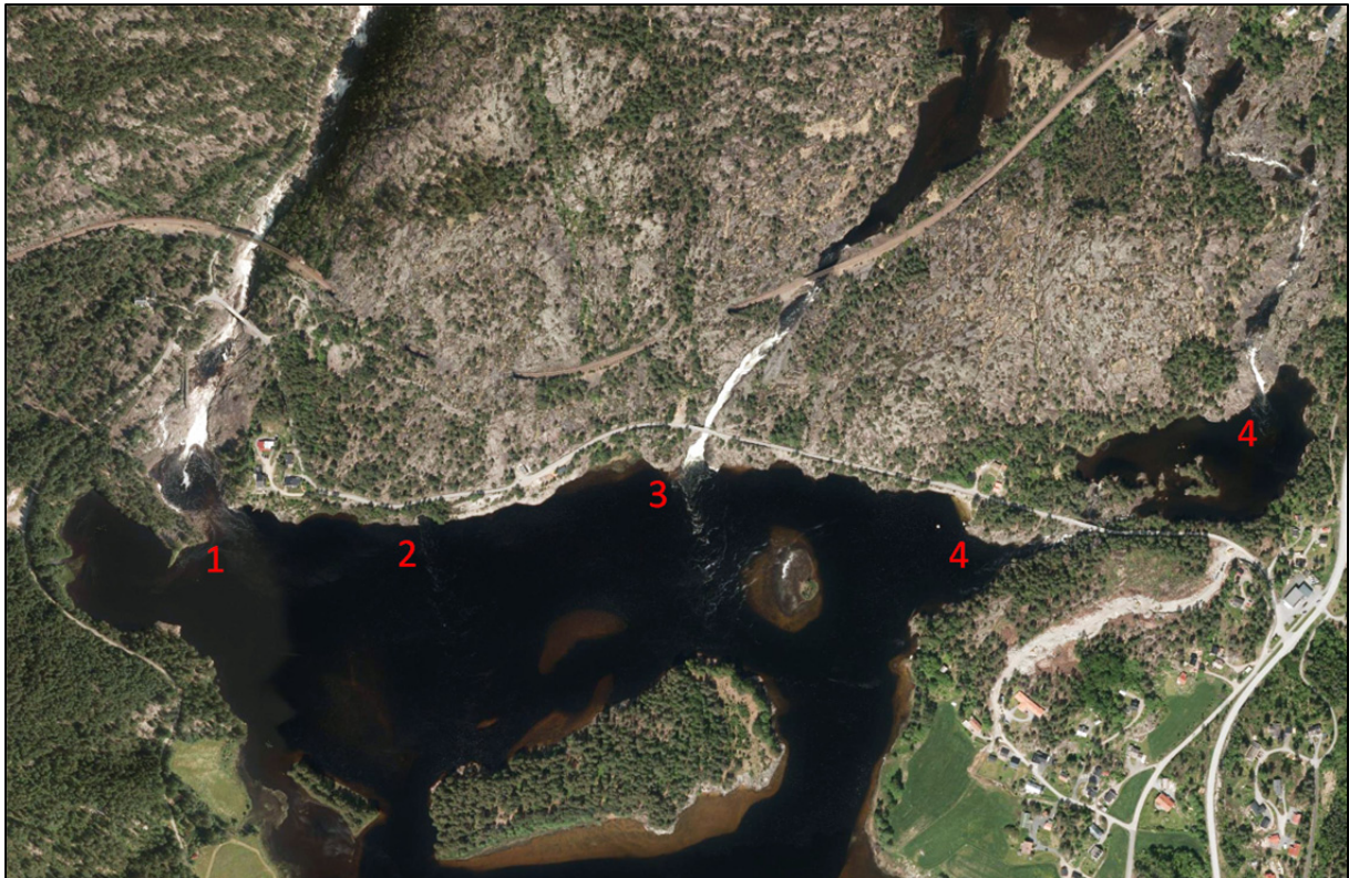
Figur 9. Det går vesentlig mer vann i Herefossen (3) enn i Laksefossen (4) og ut av Lakshøl (4). Utløp fra Hanefossen (1) og Hanefossen kraftverk (2) ses til venstre. Forskjellen i tilført vannmengde fra de ulike utløpene danner strømbildet i øvre del av Herefossfjorden, som oppvandrende fisk orienterer seg etter.
