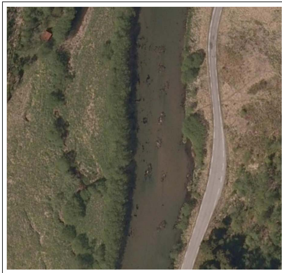
Bilde 1. Flyfoto tatt i 2008 som viser steinutlegget ved Fasteland i Teigdalselva som ble utplassert i 1994.
