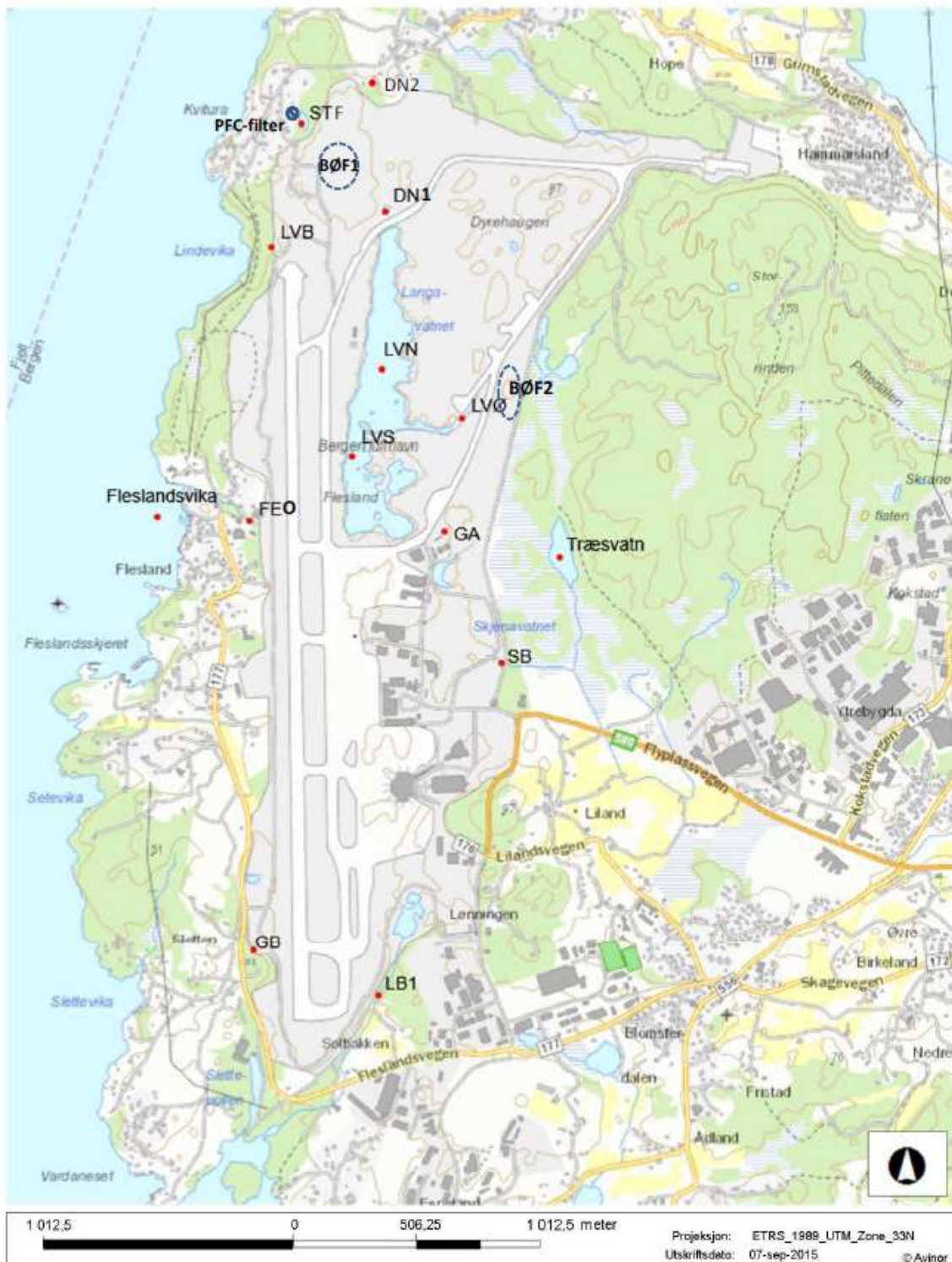
Figur 12. Område for vannprøvetaking ved Bergen Lufthavn Flesland. Plassering av stasjoner for vannprøvetaking i tjern og elver er vist med røde punkter. Plassering av utfaset brannøvningsfelt er vist med blå stiplede linje. Omtrentlig plassering av filter for perfluorerte forbindelser som er plassert oppstrøms Steinfjelltjern er vist med blå sirkel. Kart: fra 2015, modifisert etter Avinor. Stasjonsnavn: DN = Deponi nord, STF = Steinfjelltjern, BØF = Brannøvningsfelt (1 & 2), LVB = Lindevikabekken, LVN = Langavatn nord, LVØ = Langavatn øst, LVS = Langavatn sør, FEO = Fleslandselven øvre, SB = SVB = Store veitavekken, GB = Gästjörnsbekken, LB1 = Lønningsbekken. GA = GA-kanal, kun målepunkt for konduktivitet.
