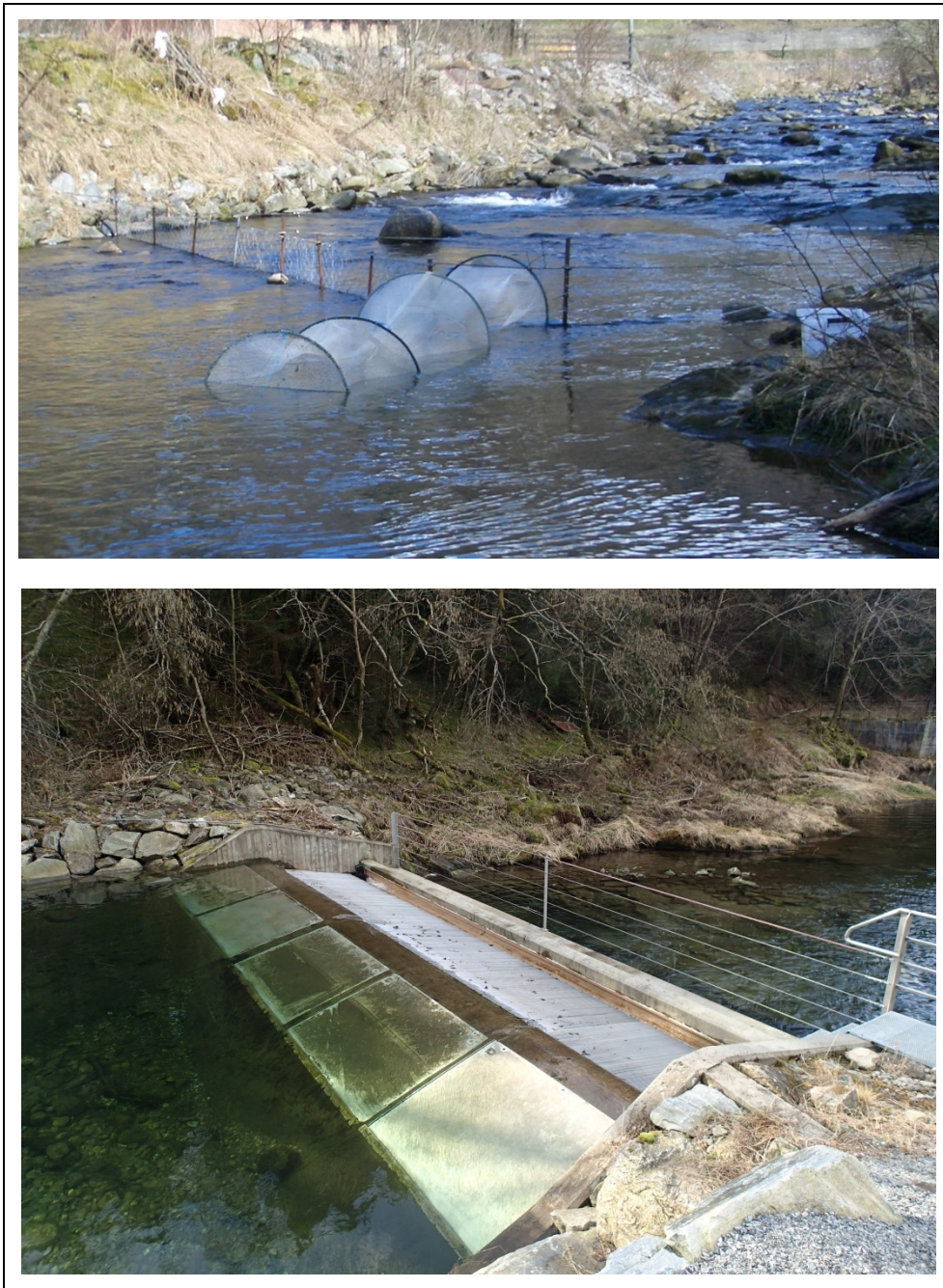
Bilde 2. Den første smoltfellen (øverst) ble etablert i 2005, mens nåværende Wolf-felle (nederst) var ferdigstilt i 2010. Disse fellene har blitt benyttet i nedre del av restfeltet i Vikja for å fange utvandrende laksesmolt om våren og sommeren.
