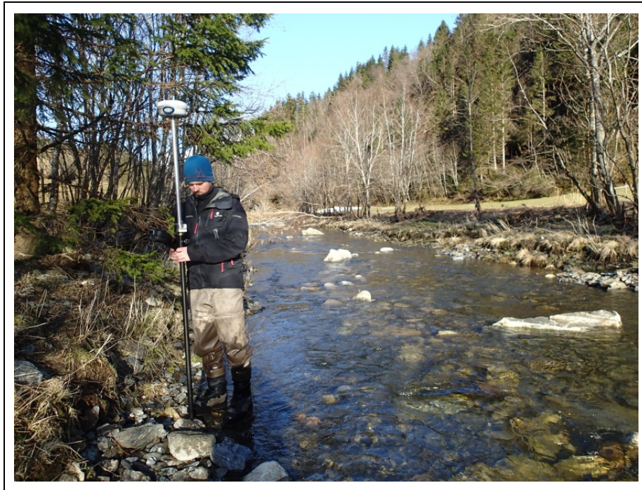
Bilde 14. Oppmålingen av det habitatjusterte restfeltet med en differensiell GPS mars 2015.
