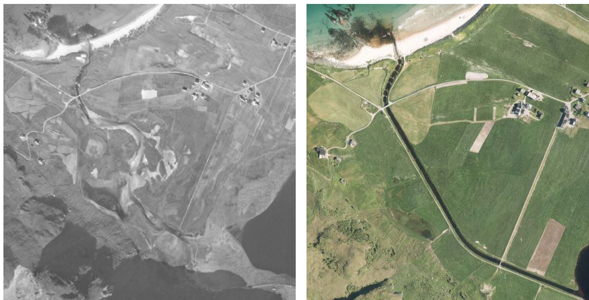
Figur 42. Historisk flyfoto fra 1968 (hentet fra norgebilder.no) sammenlignet med dagens tilstand i nedre deler av Dalsbøvassdraget. Bildene vitner om store inngrep i form av utretting og kanalisering av vassdraget.
