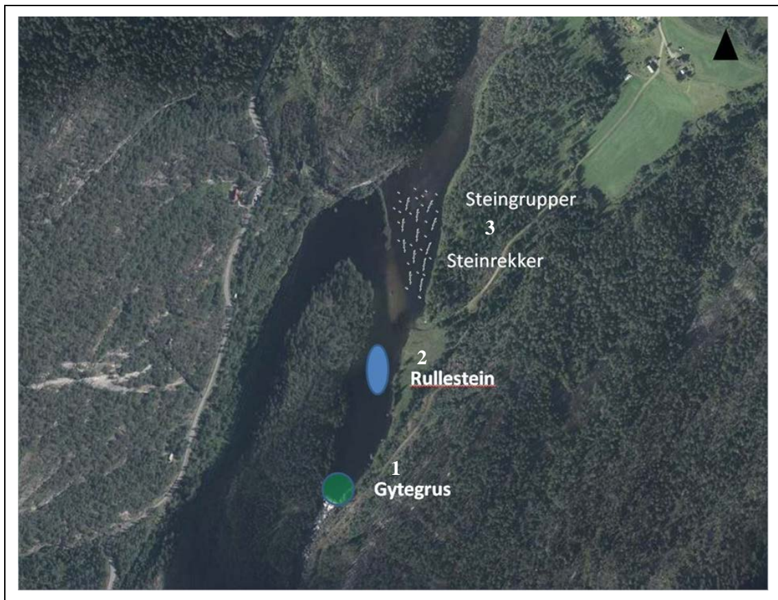
Figur 14. Oversikt over tiltak som ble gjennomført høsten 2016 i det tidligere terskelbassenget på Fetet.
