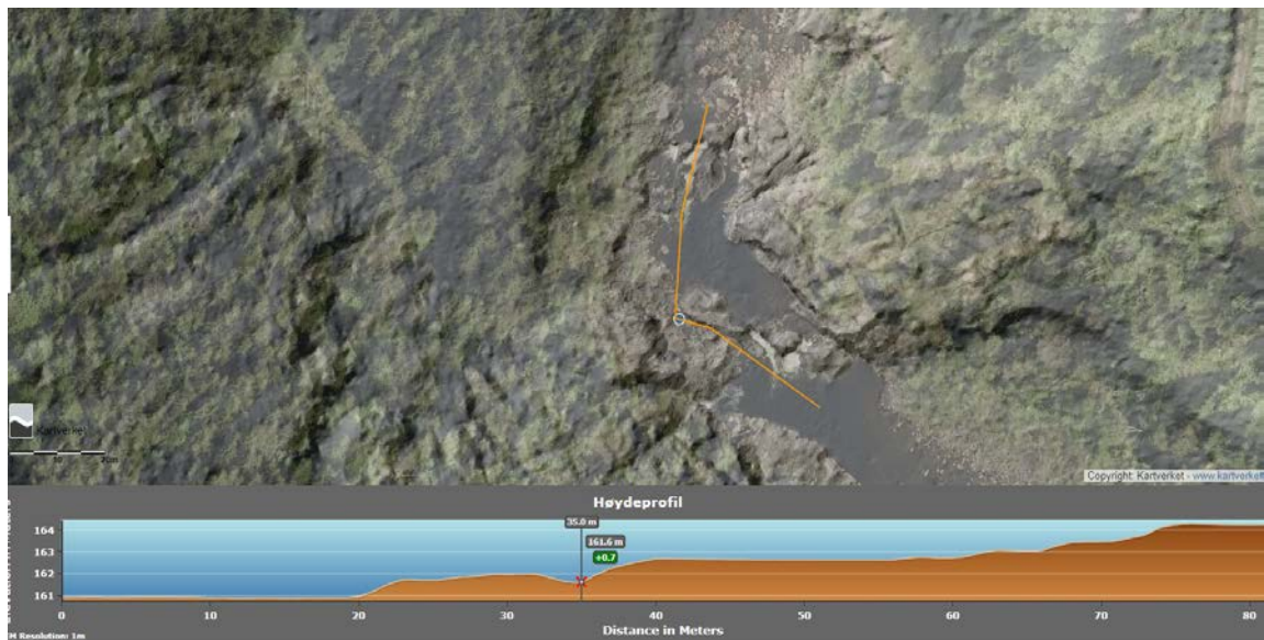
Figur 31. Høydeprofil vandringshinder 1 (kilde: kartverket). Trinnene er ca. 1 m høye. Det vanskeligste partiet (nedre foss) har en høyde på 2.6 m.
